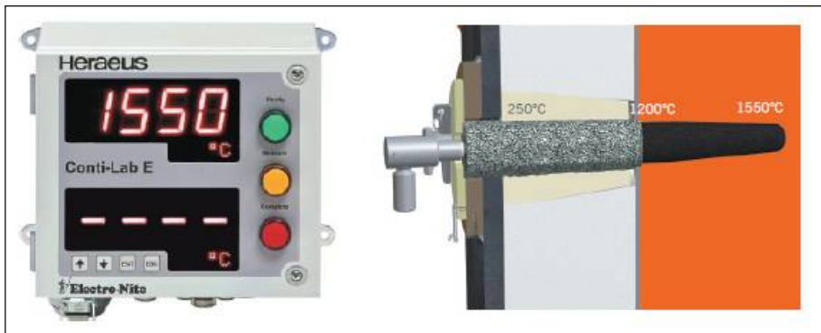
Rysunek 1. Podstawowe części składowe systemu CasTemp® – przyrząd pomiarowy Conti-Lab i zabudowany czujnik CasTemp®.
